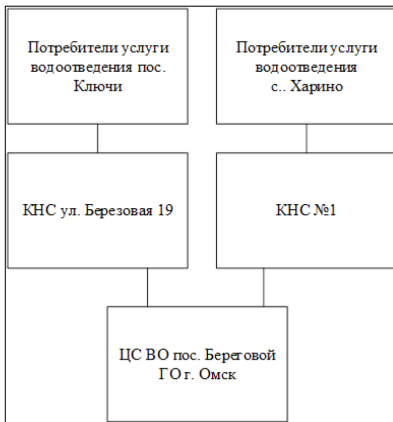
Рисунок 2.1.1 – Структурная схема централизованного водоотведения СП Ключевское
